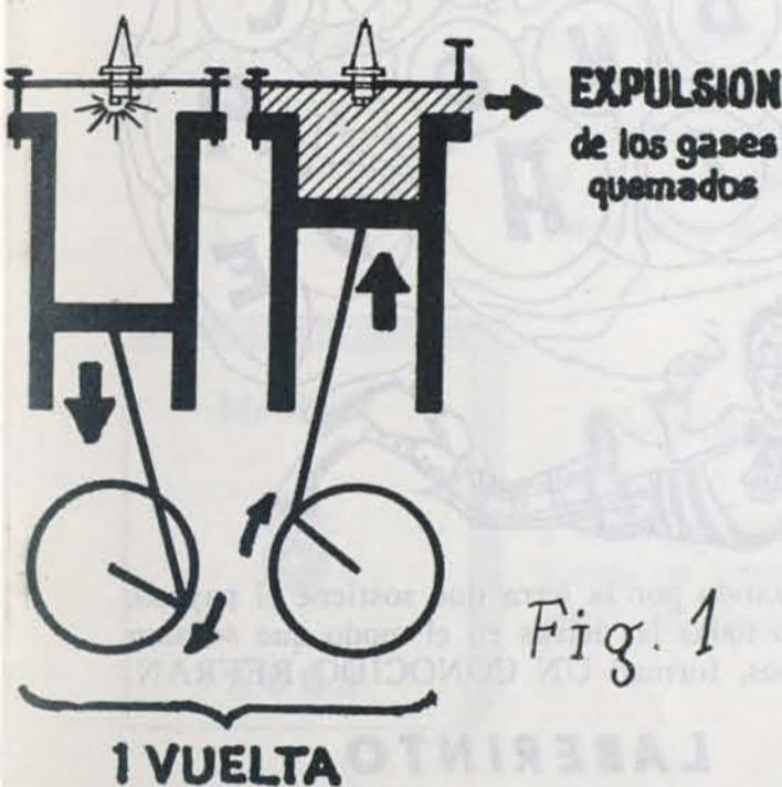
mezcla, haciéndola explotar y convirtiéndola en un gas de gran fuerza. Esa fuerza hace mover un émbolo o cilindro que transmite el movimiento, mediante un mecanismo, a las ruedas del vehículo.
