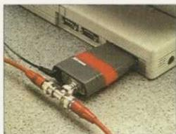
Las estaciones se conectan a la red por medio de un interfaz de red, que se encarga de dar formato a los mensajes y transmitirlos.
