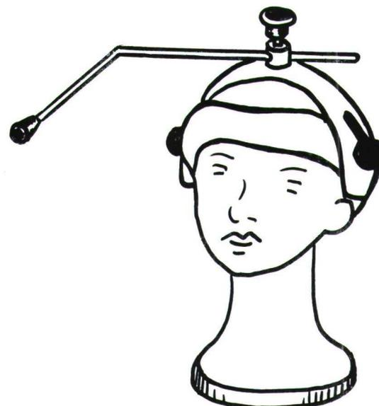
**Indicador luminoso.** Es un cabezal que permite señalar dibujos, símbolos, palabras a través de un haz de luz de color. Si el alumno no tiene un buen control cervical y utiliza este indicador, es aconsejable disponer el tablero sobre un plano inclinado, a fin de evitar que tenga que bajar la cabeza para señalar.
