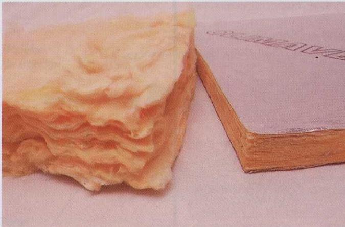
Fig. 4. Material aislante de fibra de vidrio.
