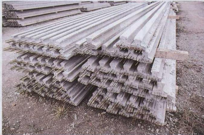
Fig. 18. Viguetas de hormigón pretensado.
