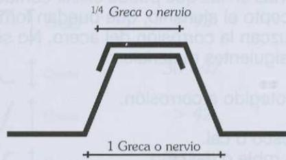
Fig. 21. Solapo lateral con perfil grecado.
