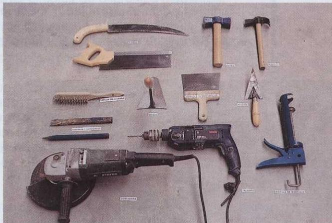
Fig. 2. Herramientas de albañilería.
