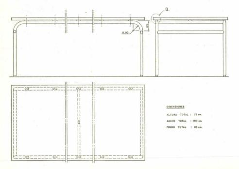
Las distintas piezas componentes de la estructura y bastidor estarán unidas entre sí mediante soldadura oxiacetilénica por arco en atmósfera inerte, no debiendo presentar después de su ejecución, coqueras, residuos ni rebabas hirientes.
