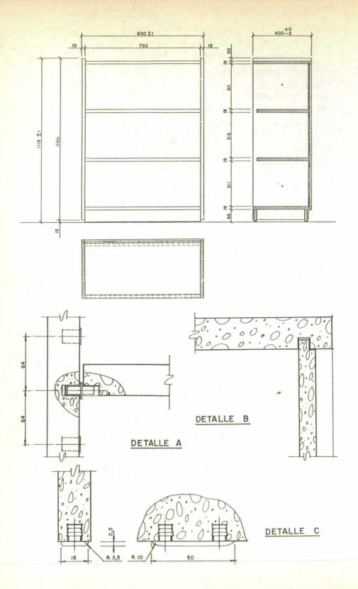
3.1.1 Materiales.—Se utilizarán a este fin tableros de madera aglomerada de espesor nominal de 19 milímetros en armazón, baldas y zócalo; la trasera será de 10 milímetros. Las densidades mínimas serán de 650 kilogramos/metro cúbico.
