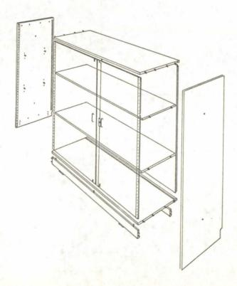
El frente vendrá cerrado por dos puertas de madera aglomerada de 16 milímetros de espesor y montado sobre bisagra de tipo piano. Dichas puertas estarán dotadas de cerradura de falleba en su parte central una de ellas, y la otra, con pestañas en sus partes superior e inferior.
