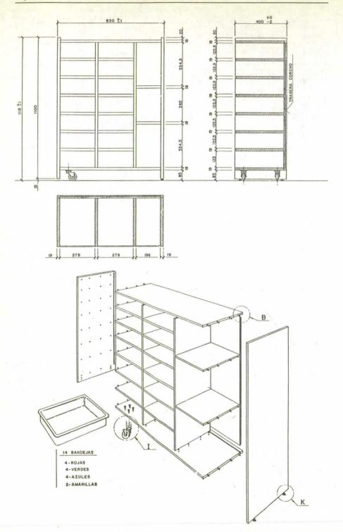
3.1.1 Materiales.—Se utilizarán a este fin tableros de madera aglomerada, de 19 milímetros en armazón, baldas y zócalo. Las densidades mínimas serán de 650 kilogramos por metro cúbico
