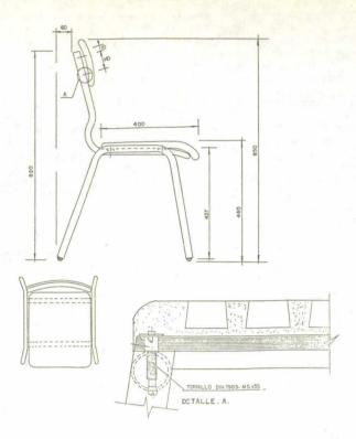
El sistema de arriostramiento del asiento con la armadura se realizará por dos pletinas, en sentido tansversal, de 20 milímetros de ancho por 3 milímetros de espesor, incorporando cuatro tornillos (dos por pletina).
