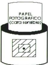
**4** En el cuarto oscuro y con la lámpara de seguridad, introducir el papel fotográfico con la cara sensible hacia el orificio.
