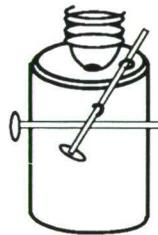
3. Atravesar lateralmente otro clavo, con la bombilla colocada, de forma que permita enroscar la bombilla tocando el clavo a su rosca.
