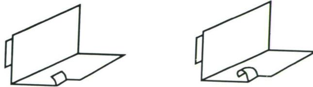
3. Presionando un poco, colocarlos en los polos de la pila (uno más separado que el otro, para no confundir después la polaridad) y pegarlos a la madera en la posición que ellos mismos pidan. Una buena presión de los polos hace que la conexión sea óptima.
