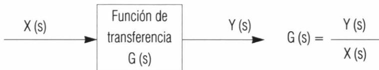
La función de transferencia se define como la relación entre la transformada de Laplace de la entrada y la transformada de Laplace de la salida, considerando las condiciones iniciales nulas.
