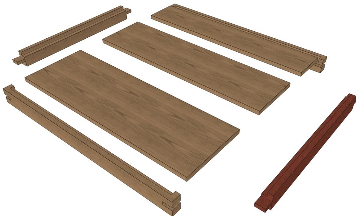
**Figura 5.6.** Despiece de la cubierta. Imagen: Abel Vega Cueto.
