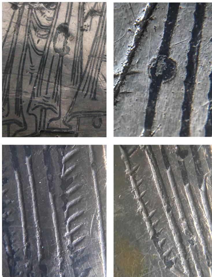
**Figura 7.** Arriba, detalles de las figuras de la tapa donde el niel ha ocupado una oquedad existente, posible evidencia del grabado al ácido. Abajo, dos detalles de la tapa donde se ven trazos transversales practicados de manera que han dejado una muesca en ambos lados del trazo que atraviesan, posible evidencia del grabado a buril. Fotografías: Emilia González.
