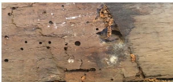
**Figura 1.** Detalle de los tableros constituyentes del interior del Arca Santa. Es posible ver los orificios correspondientes a ataques antiguos de insectos, junto con depósitos de diverso origen y suciedad acumulada.
