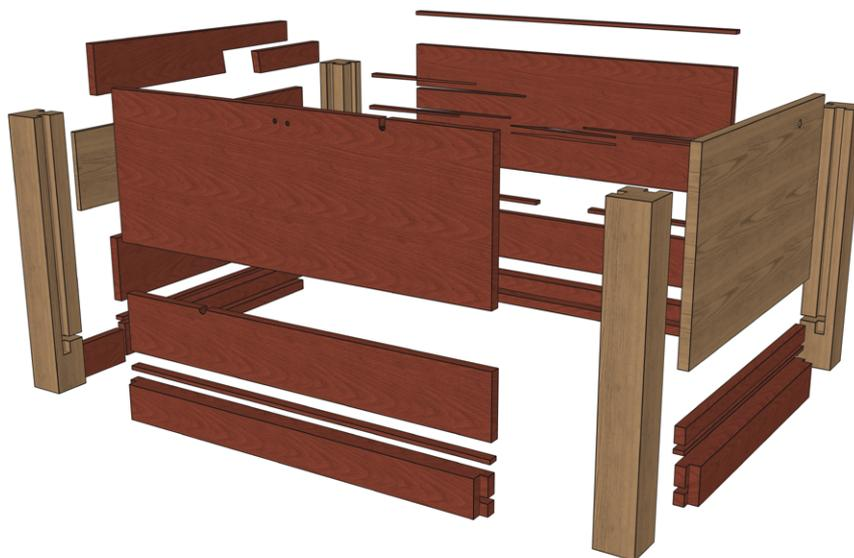
**Figura 5.2.** Despiece del cajón (cara frontal y lateral derecho). Imagen: Abel Vega Cueto.
