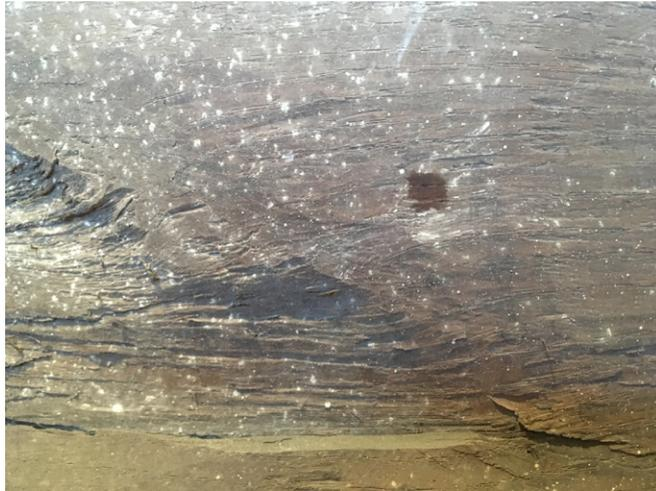
**Figura 3.** Zona de acumulación de depósitos blanquecinos y pulverulentos. Es posible apreciar la zona de muestreo para análisis microbiológico, de una superficie aproximada de 1 cm<sup>2</sup>. La toma de muestras se llevó a cabo mediante frotado de torunda humedecida en solución salina estéril.
