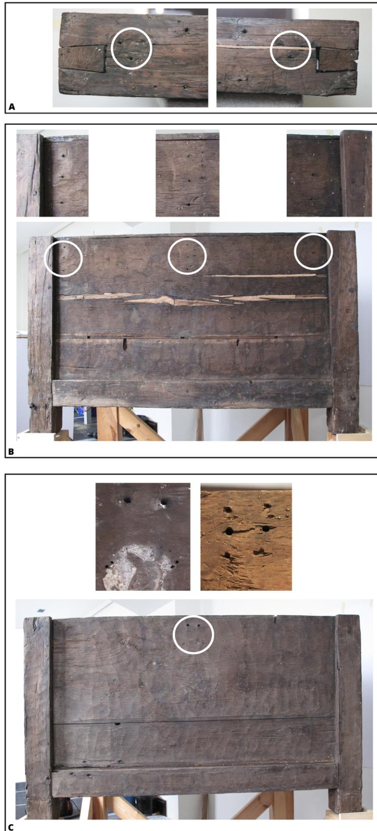
**Figura 1.** Vestigio de los herrajes en el alma de madera. A: de dos herrajes en la parte posterior de la tapa, presumiblemente un modo de cierre anterior al de los cuatro herrajes alargados; B: vestigios en la trasera de la clavazón de tres herrajes alargados; C: orificios en el panel frontal, señal de la existencia de un cierre, con detalle desde el exterior y desde el interior. Fotografías: Talleres de Arte Granda.
