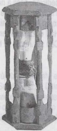
El reloj de arena era, para los navegantes del siglo XVI, el principal instrumento de medida del tiempo. Por lo general estaban contruidos para medir las horas y las medias, y se podían calcular los cuartos. Era frecuente que se obturasen por causa de la humedad.
