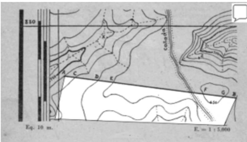
FIGURA 2.10: Construcción de perfiles topográficos
