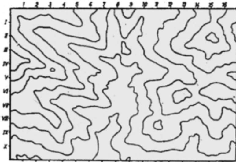
larlo. La realización de perfiles topográficos de cada etapa nos puede ser muy útil para calcular estos desniveles. Para realizar un perfil tienes que situar un folio de papel sobre la línea que indica el camino seguido. En este folio irás señalando las diferentes curvas de nivel y su altura. Después trasladarás esta información a un gráfico.
