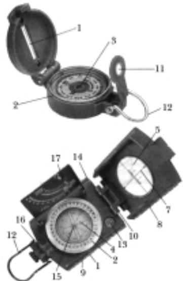
Aun así, para orientarnos con más exactitud y precisión, utilizaremos una herramienta que nos facilitará bastante el trabajo: la brújula. Una brújula no es más que una aguja imantada montada sobre un bastidor y que siempre apunta al norte. Además presenta un círculo graduado con los cuatro puntos cardinales y el círculo dividido en 360 grados.
