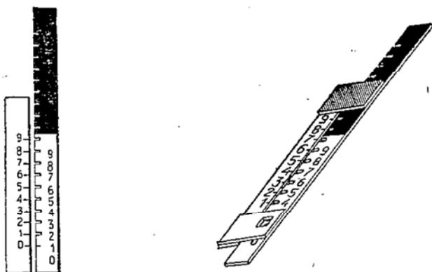
la figura. La escala de la izquierda va fija con divisiones equidistantes de centímetro en centímetro y numeradas de cero a nueve. En la escala de la derecha los trazos se sustituyen por orificios o ranuras en las que penetra la punta de un punzón que le imprime el movimiento de deslizamiento.
