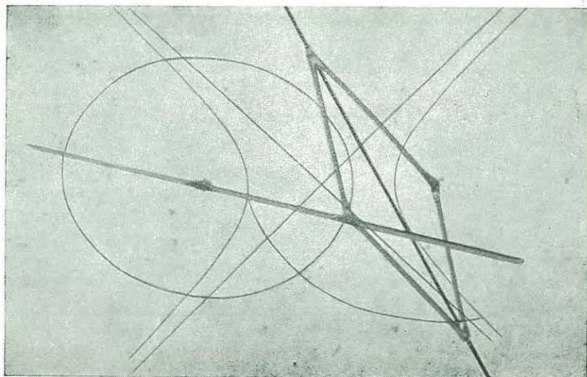
Generación puntual y tangencial de la hipérbola (sistema de deslizamiento y articulación (Servais-Bélgica)
