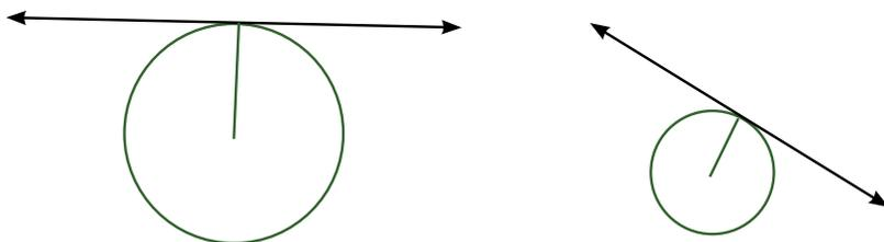
**Figura 9.** Construcción de la tangente a una circunferencia.
