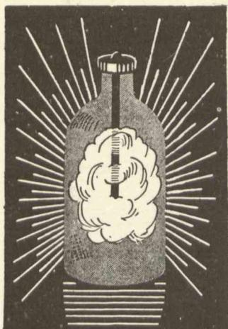
21. Técnicas de laboratorio: obtención del óxido de magnesio. Introduzcamos en un frasco lleno oxígeno una cinta de magnesio encendida. Arde produciendo una luz deslumbradora y una densa nube de humos blancos de *óxido de magnesio*.
