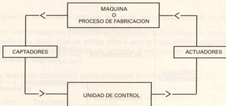
La información, proveniente de la máquina, es recogida y transformada convenientemente por los captadores que la envían a la unidad de control que genera las órdenes correspondientes, éstas se transmiten a la máquina a través de los actuadores o accionadores que las transforman en magnitudes con el nivel de potencia adecuado para interactuar sobre ella.
