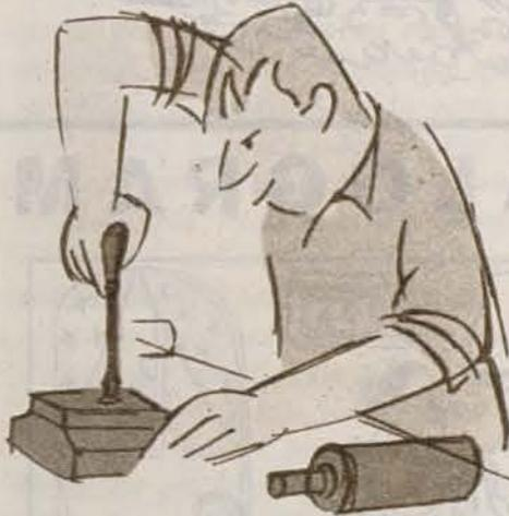
El destornillador debe ir vertical sobre la ranura del tornillo.
