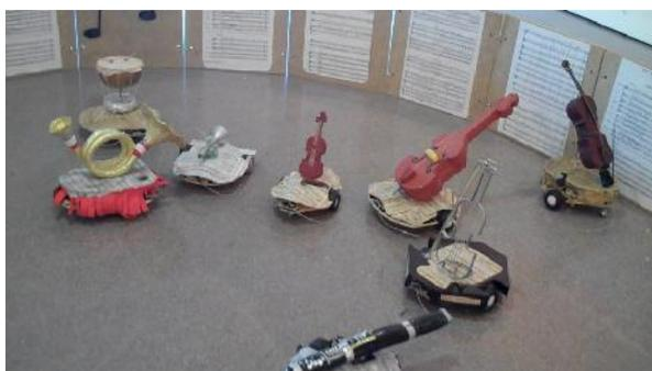
Estos sencillos robots sortean los obstáculos tras chocar con ellos. Cada ejemplar incluye dos sensores táctiles de colisión en su parte delantera, de forma que, cuando está en funcionamiento y colisiona con un obstáculo, el robot gira en sentido contrario hasta separarse de él y seguir su camino.
