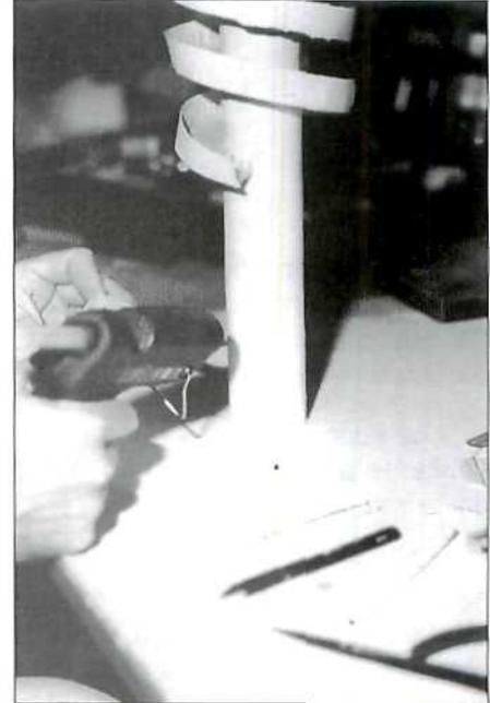
Con el fin de retardar la caída de la canica en el tramo de esta rampa recta, se adhieren a su fondo unos obstáculos en forma de ángulos de cartón que cortan en zig-zag la trayectoria de la canica, obligándola a alargar el camino y retrasar su desplazamiento.
