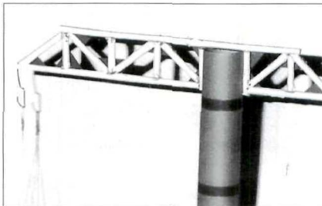
En este caso se han construido dos plataformas con tapones de plástico para que, a modo de platillos de una balanza, puedan sostener el peso previsto. Para este ejemplo se han utilizado monedas. En el platillo del brazo largo se coloca la mitad de monedas que en el corto (Recuérdese lo expresado sobre la palanca de primer género en la Unidad Didáctica anterior).
