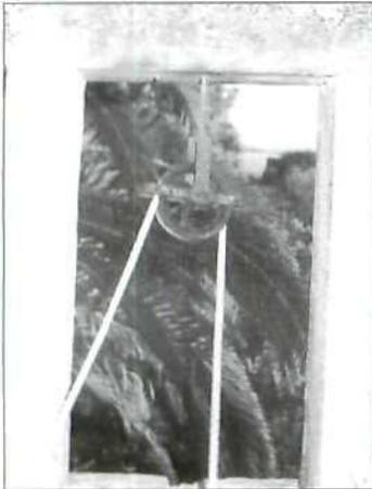
Básicamente, una polea es una rueda acanalada, con un eje central perpendicular al plano de la misma. En la acanaladura se sitúa la correa de transmisión. La correa es el elemento de conexión entre la **resistencia** y la **potencia**, aplicadas en cada uno de sus extremos.
