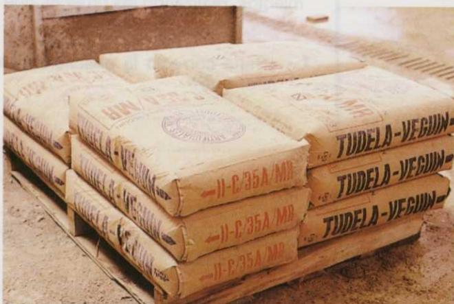
Fig. 14. Apilado de cemento sobre tablero de madera.
