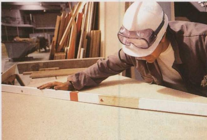
Fig. 1. Ensayo físico: defecto de planimetría.
