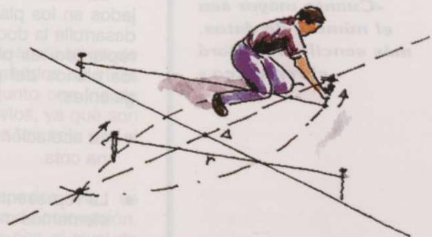
Fig. 13. Otra forma de trazado de perpendicular.
