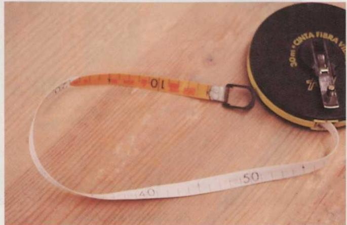
Fig. 3. La cinta viene graduada en 1/2 cm, cm y m.
