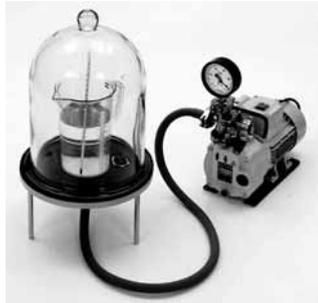
Al hacer vacío vemos que el agua puede hervir a temperaturas inferiores a los 100 °C (en nuestra campana a 60 °C); por tanto, con menos calor se puede lograr el mismo resultado. Si extraemos el vapor generado para condensarlo en otra etapa del proceso, y mantenemos un cierto vacío en la zona en la que se produce, se podrá mejorar mucho la rentabilidad del proceso.
