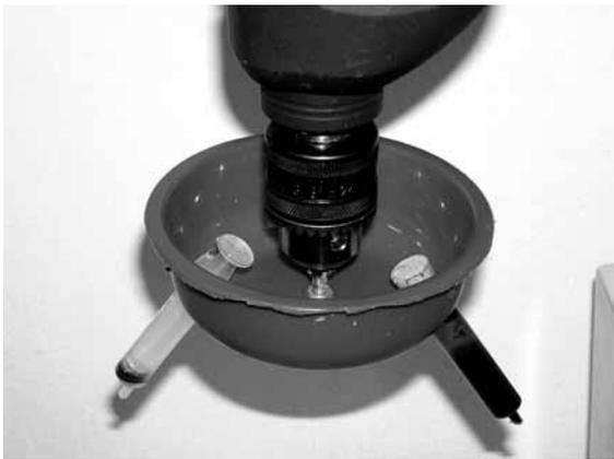
Echamos la sangre en uno de los tubos y agua en el otro (para compensar las masas), acoplamos la centrífuga al taladro del taller de tecnología y lo pusimos a girar unos segundos. Al detenerse, vimos un líquido amarillento arriba y un líquido de color rojo intenso abajo.
