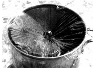
Al colocar el arreglo experimental (figura 7.1a y 7.1b) toda una mañana al Sol, se observó la condensación en el plástico y algunas gotas desalinizadas fueron recogidas en el recipiente. Pero el proceso era demasiado lento; ¿cómo poder aumentar la cantidad de agua desalinizada? A los alumnos se les ocurrieron algunas ideas:
