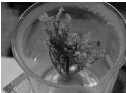
momento, el ácido benzoico experimenta una sublimación, pero, en contacto con el vidrio de reloj, más frío, sufre un proceso de sublimación inversa, depositándose sobre la ramita con un efecto de nevada, tal y como puede verse en la siguiente imagen.
