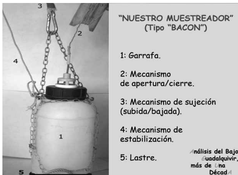
FIGURA 1.12: La recogida de las muestras de agua se realiza con nuestro muestreador (tipo bacon)
