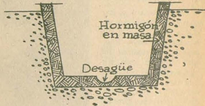
Corte transversal de un silo-zanja revestido.
