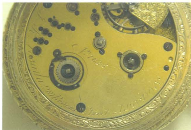
Detalle del sistema para dar cuerda por medio de llave en el que se distinguen los destinados a carga de movimiento, sonería y puesta en hora del reloj cronómetro con número de serie 1625 (Nº de inventario: 2004/15/1)
