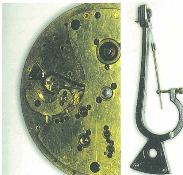
Maquinaria del reloj cronómetro con número de serie 1625 y detalle del escape (Nº de inventario: 2004/15/1)
