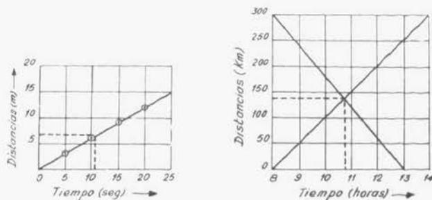
Fig. 3 a) Representación gráfica del movimiento uniforme
