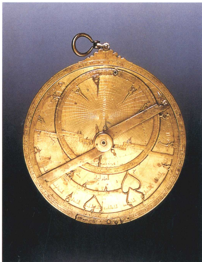
Astrolabio. Según reza su inscripción en árabe, fue fabricado por Ibrahim Ibn Said en Toledo en el año 1067. Es uno de los más antiguos conservados. Estos instrumentos servían para orientarse y conocer la latitud de un lugar a partir de la posición de las estrellas en la bóveda celeste, trasladada en ellos a una representación sobre su placa. Para facilitar la tarea, Ibn Said marcó en esta placa la posición de las estrellas en más de treinta ciudades del mundo islámico, desde la Meca hasta Huesca. (Astrolabio similar en Sala 30, vit. 5).
