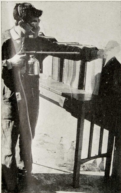
Figura 7.—Tratamiento de libros con aerosoles especiales: Prueba previa con un papel para comprobar la distancia mínima que necesita el chorro del líquido para transformarse en aerosol
