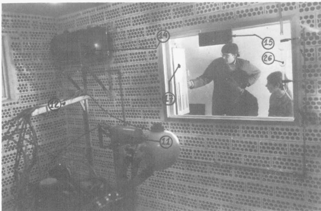
11. Servomotor mando acelerador. 12. Columna recogida de cableado. 14. Depósito de combustible. 15. Unidad barométrica. 17. Manómetros de columna. 26. Burbujas de combustible.
